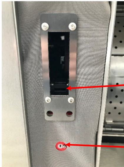
Vis de verrouillage de la sécurité de porte
