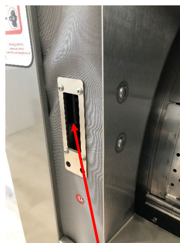
Le capteur magnétique est placé à l'intérieur de la machine
