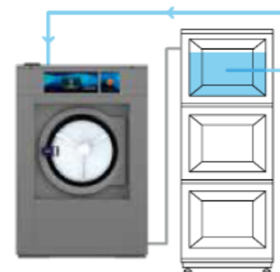
ECONOMIES D'EAU BAC 3 Eau du lavage pour le prochain pré-lavage
