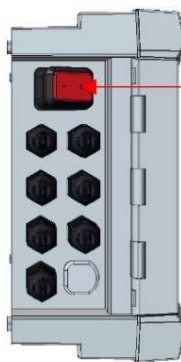
Fig. 12.1- unité de console, vue du côté gauche montrant les trous de câblage (en détail)
